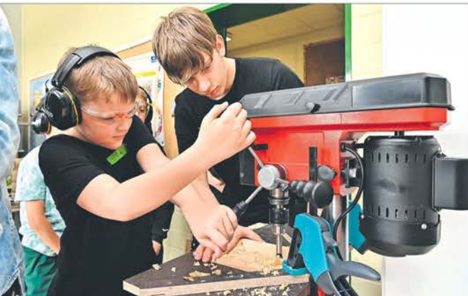
Konzentriert bohrt Cian das Meisselnloch in das vorbereitete Bauteil. Foto: Schmeißbach
